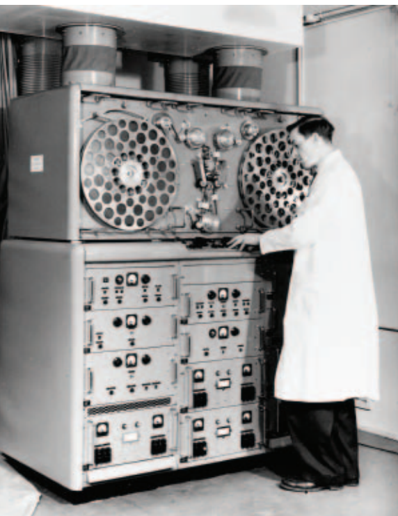
Экспериментальный аппарат VERA (Vision Electronic Recording Apparatus), разработанный Би-би-си. Фото 1958 года
