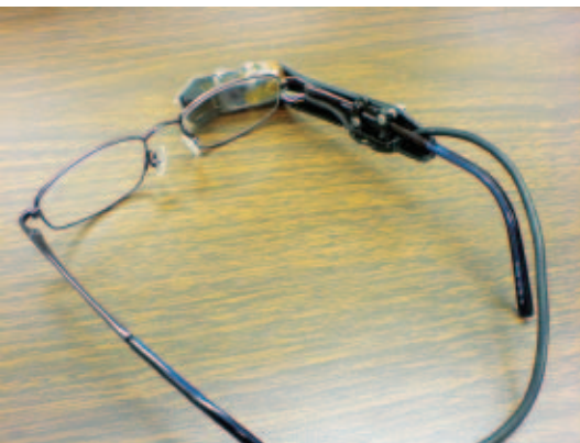
HUD, закрепленный на дужке очков
